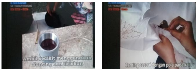
Gambar 1.11 proses mencanting kain sesuai dengan pola
